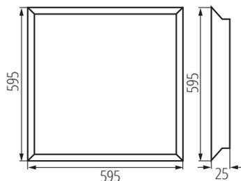
Светодиодная панель для скрытой установки
